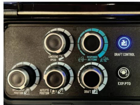
Contrôle d'attelage à 3 points
